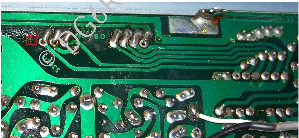
Leiterbahnen an den markierten Stellen auftrennen und PLL Pin's von Masse trennen (einzeln).
