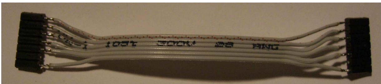
Einzelne Buchsenleiste an langes Kabel von PLL löten und mit den anderen Kabeln bündeln.
